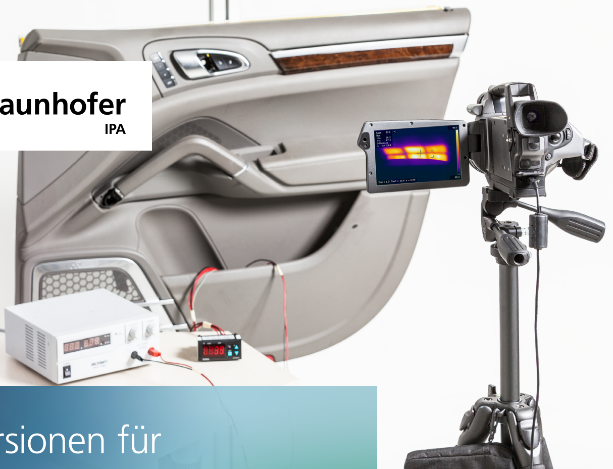
Wärmebildaufnahme einer integrierten Flächenheizung, Quelle Fraunhofer IPA.
